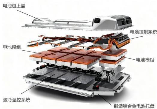
图 1 电池包结构
